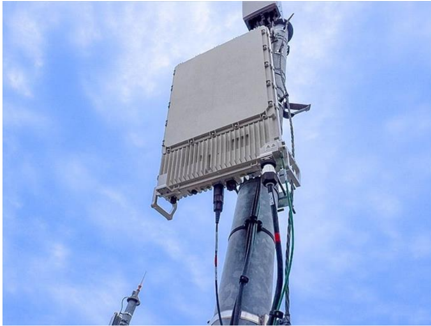
図 2-5 KDDI が商用展開したオープン化された 5G 仮想化基地局 出所) KDDI 報道発表資料
