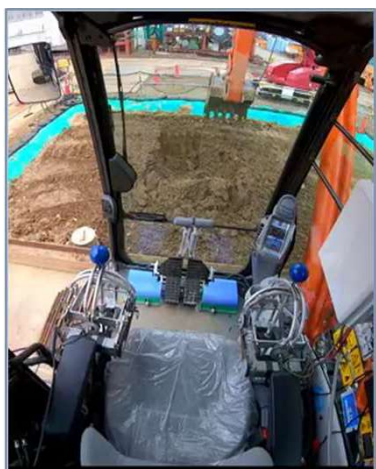
ロボット化した操作室 油圧ショベルの自律運転 (掘削・積込の自動化)
